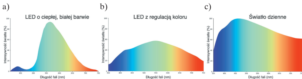
Rys. 1. Porównanie spektrum światła: a) klasyczny LED o ciepłej białej barwie; b) biały LED o zmodyfikowanej charakterystyce; c) światło słoneczne Źródło: opracowanie własne na podstawie www.led-professional.com
