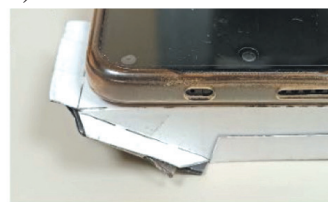
Rys. 4. Elementy spektroskopu: a) model gotowy do sklejenia, wycięty kwadrat stanowi otwór dla detektora, sześciokątny jest miejscem na siatkę dyfrakcyjną przyklejoną od zewnętrznej strony, za którą znajduje się ścianka; b) widok szczeliny o grubości około 150 \mu\text{m} (obliczone na podstawie zdjęcia przy użyciu programu ImageJ Fiji [5]); c) aparat telefoniczny przyłożony do otworu na detektor
