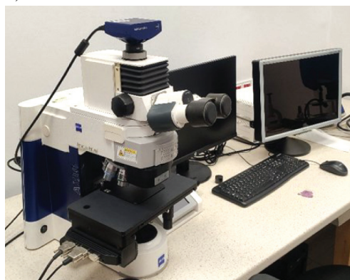
Rys. 2. Mikroskopy użyte do badań metalograficznych: a) mikroskop świetlny firmy Zeiss; b) skaningowy mikroskop elektronowy firmy Zeiss
