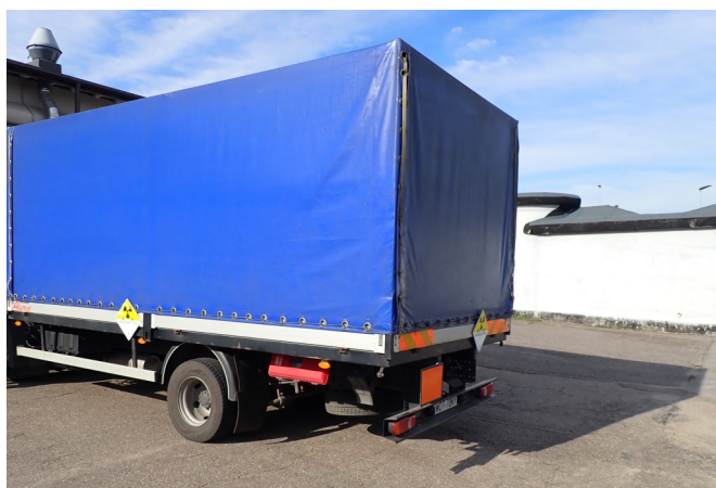
Rys. 5. Oznakowanie pojazdu transportującego odpady promieniotwórcze (źródło własne).
