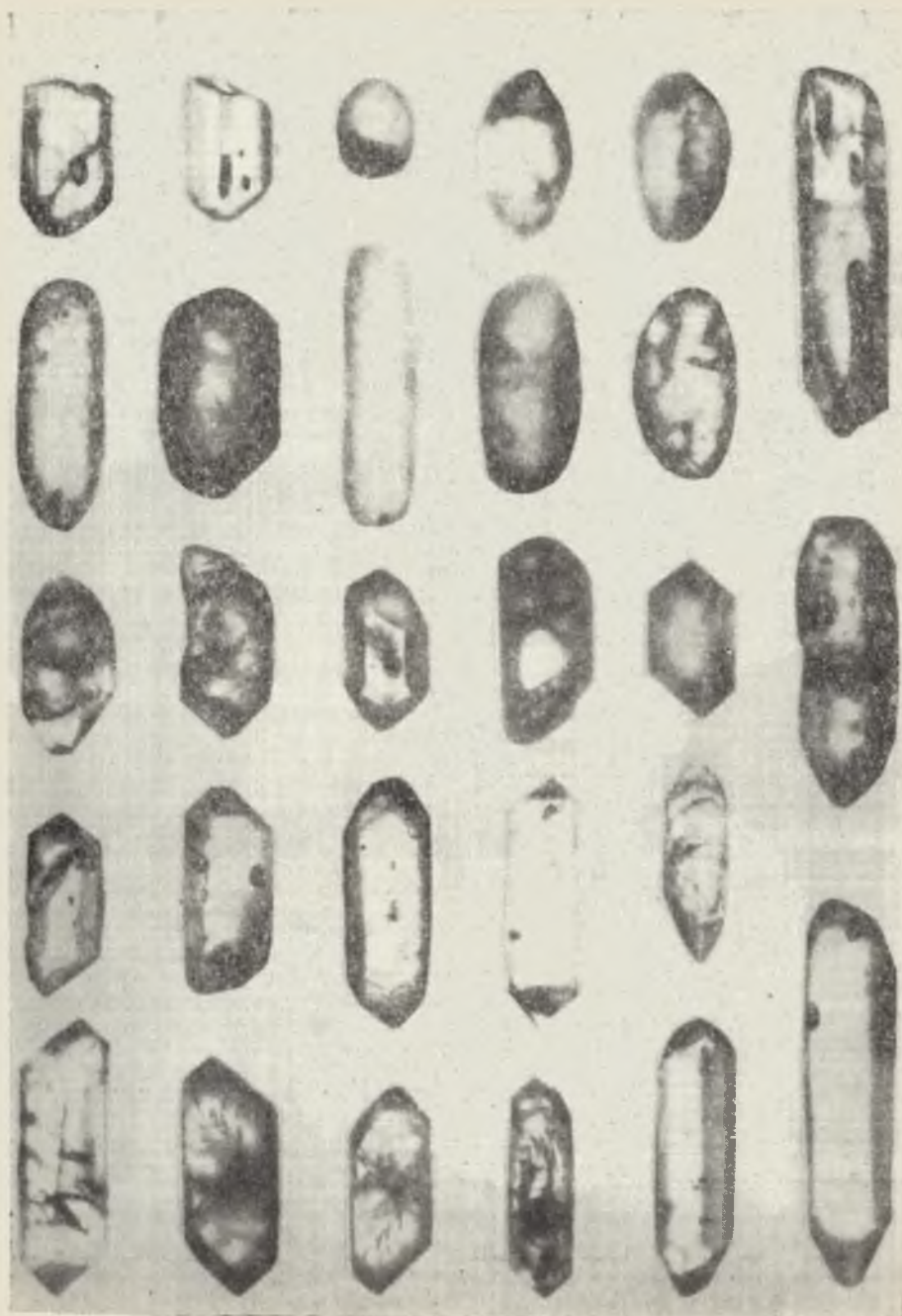
Ryc. 2. Kryształy cyrkonu o różnym stopniu obtoczenia Zirkonkristalle von verschiedentlichen Abrundungsgrad
