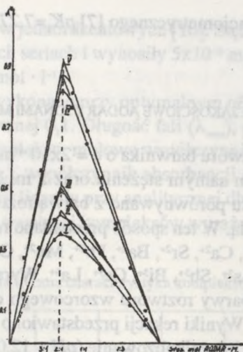
Ryc. 2. Krzywe Joba dla stężeń L+M c=1 \cdot 10^{-4} mol \cdot l ^{-1} i układu: I AODAR—Fe ^{2+} pH=8,35 = 530; II AODAR—Ni pH=9,23 =510; III AODAR—Fe ^{3+} pH=9,23 =540; IV AODAR—Co pH=9,23 =510; V AODAR—In ^{3+} pH=8,35 =530
