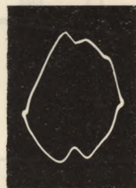
Ryc. 10. Oscylopolarogram CuCl 2 w ANL w temp. 22° C
