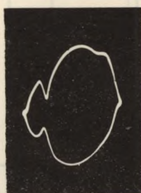
Ryc. 9. Oscylopolarogram PbCl 2 w ANL w temp. 22° C
