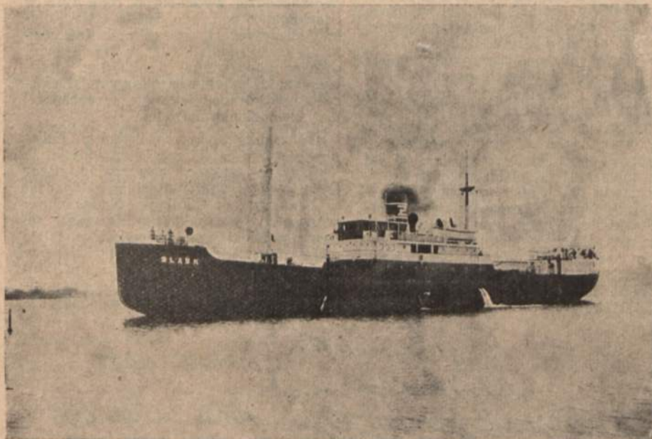
Nowy nabytek P. P. „Żegluga Polska” statek „Śląsk”, zbudowany przez stocznię w Nakšøw (Danja). Zwraca uwagę podniesiony, jak u lodolamacza dziób statku, dzięki któremu statek może torować sobie drogę wśród lodów.
