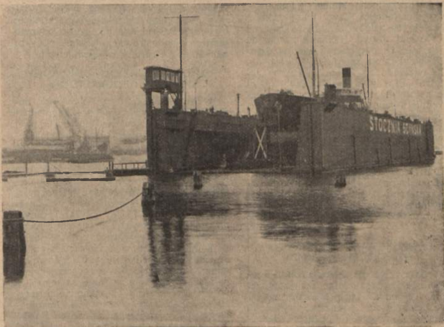
Dołk pływający Stoczni Gdynińskiej umożliwia naprawianie na miejscu statków do 5.000 ton nośności. W dołku widać statek szwedzki „Ture” z Malmö (3.000 ton), który najechał przy wyjściu z portu na zatopione łesony i odniósł uszkodzenie dna.
