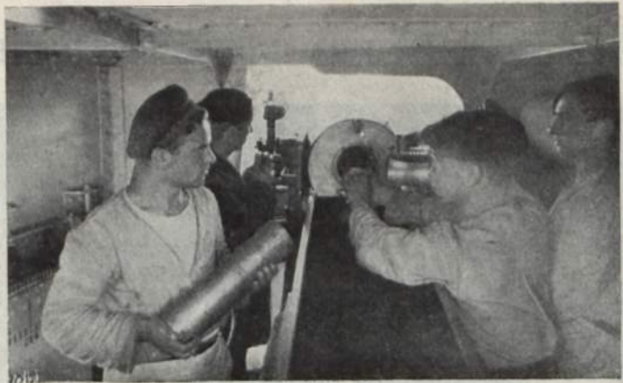
Flotylla pińska: Na monitorze polskim „Toruń”. Artylerja w wieży monitora podczas strzelania. Nabój składa się z dwóch części: pocisku, który został włożony, i gilzy z substancją wybuchową.
