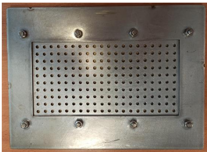
Rysunek 10. Płytkę ze stali nierdzewnej wykorzystywana do uzyskiwania kształtek nawozów na bazie azotanu(V) amonu w skali laboratoryjnej.
