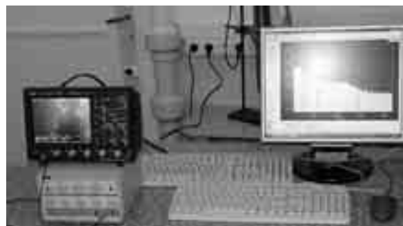
Szybki oscyloskop cyfrowy i ekran oprogramowania GENIE-2000 służącego do sterowania spektrometrem promieniowania gamma oraz analizy wyników pomiarów
