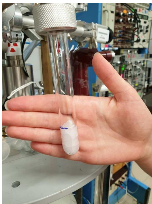
Rys. 64. Zamrożona woda w probówce podłączonej do układu pomiarowego. Odgazowywanie wody w celu usunięcia z niej tlenu [175].
