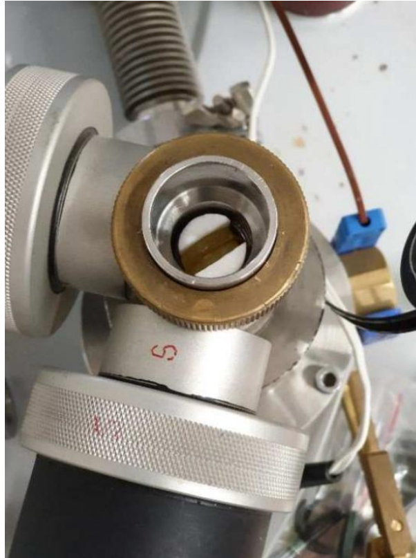
Rys. 67. Zdjęcie próbki znajdującej się w uchwycie teflonowym umieszczonej w komorze pomiarowej. Na zdjęciu są widoczne detektory scyntylacyjne [175].
