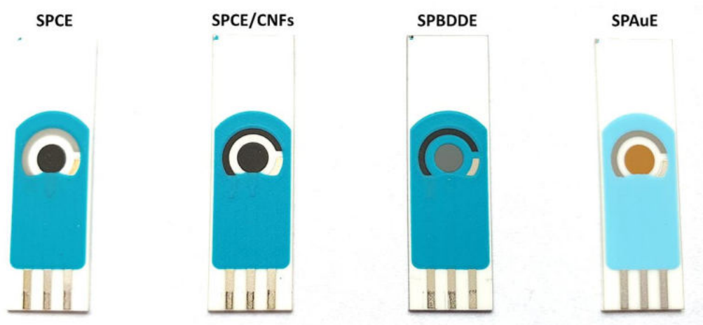
Rys. 1. Dostępne w handlu czujniki sitodrukowane wykorzystywane w trakcie badań (SPCE – sitodrukowana elektroda węglowa, SPCE/CNFs – sitodrukowana elektroda węglowa modyfikowana warstwą nanowłókien węglowych, SPBDDE – sitodrukowana elektroda diamentowa domieszkowana borem, SPAuE – sitodrukowana elektroda złota) [opracowanie własne].
