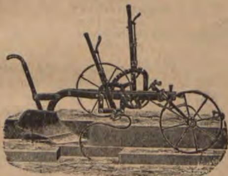
Rys. 4. Dwuskibowiec przerobiony na jednoskibowiec ze sprężynowym pogłębiaczem.
