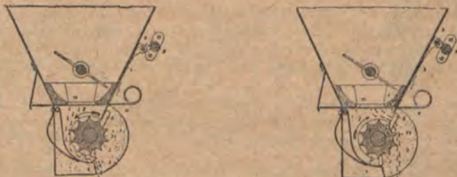
Rys. 4. Schemat siewu dolnego (na lewo) i górnego (na prawo).
