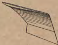
Rys. 2. Odkładnica lekko odgięta na gleby średnie.
