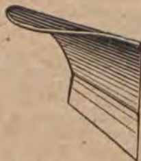
Rys. 1. Odkładnica mocno odgięta na gleby cięższe.
