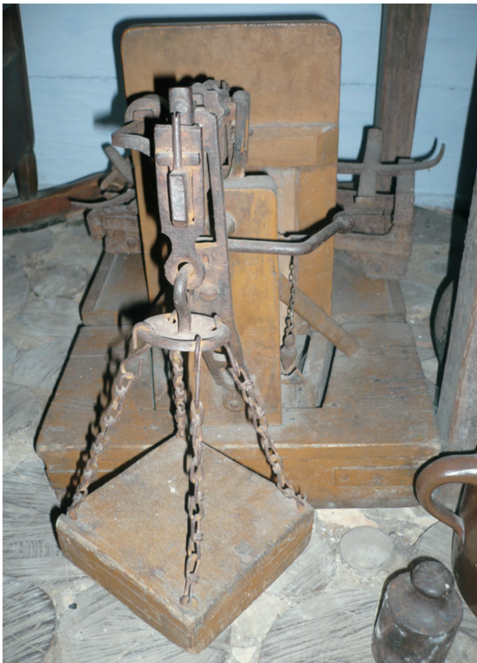
Ilustracja 18. Waga – przyrząd do pomiaru masy lub ciężaru, działający na zasadzie dźwigni
