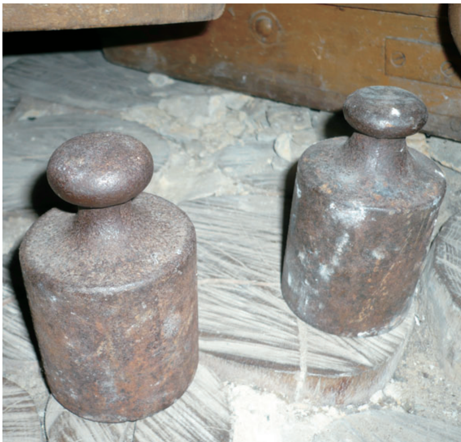
Ilustracja 19. Wycechowany ciężarek metalowy, służący do ważenia na wadze dźwigowej Nazwy: ciężarek, odważnik.
