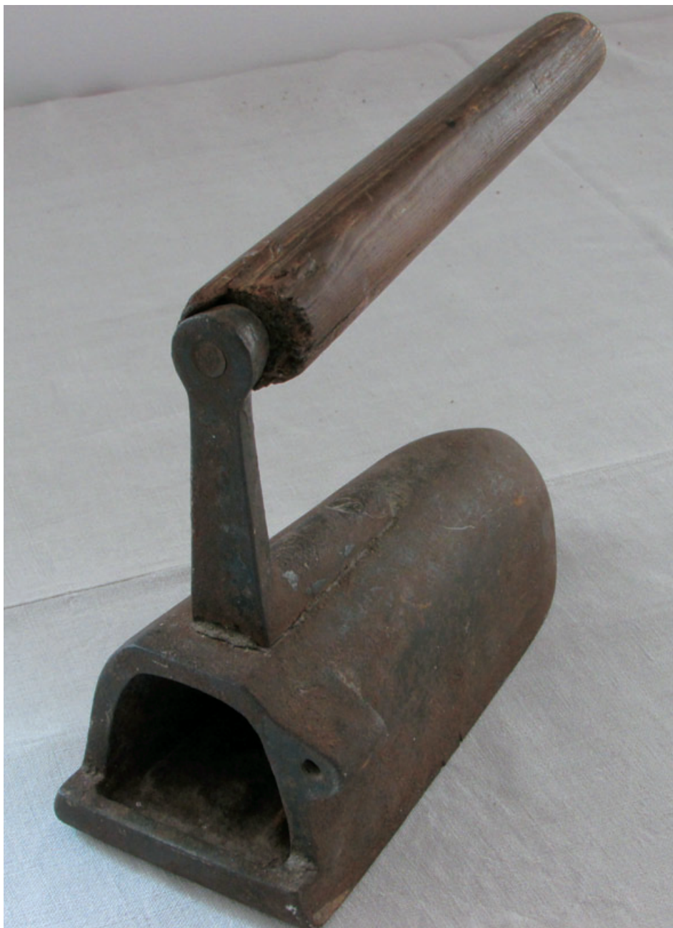
Ilustracja 20. Narzędzie do prasowania tkanin z rozgrzaną sztabką żelaza wkładaną do środka (ze zbiorów Ośrodka Edukacji Regionalnej w Hołownie)
