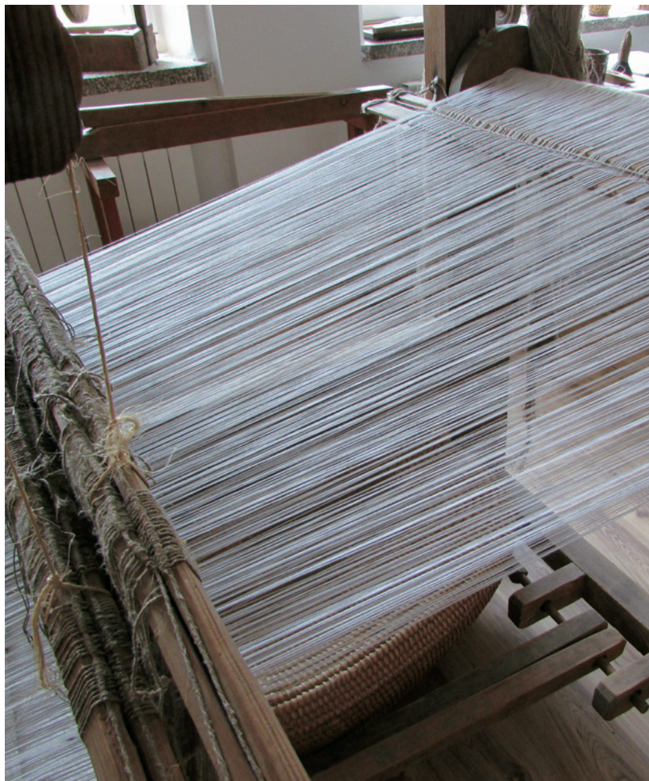
Ilustracja 28. Osnowa – przędza idąca od nawoju przedniego do tylnego w warsztacie tkackim (ze zbiorów Ośrodka Edukacji Regionalnej w Hołownie)
