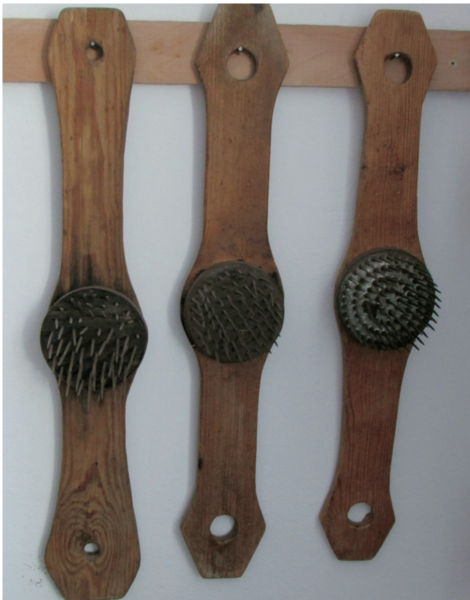
Ilustracja 20. Narzędzie służące do czesania lnu (ze zbiorów Ośrodka Edukacji Regionalnej w Hołownie)
