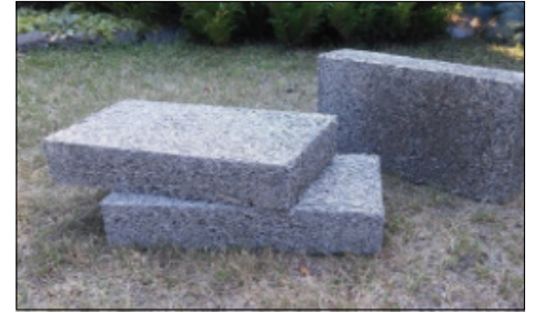
Ryc. 3. Blok konopny. Źródło: https://hempiflax.com/product/blok-konopny-do-budowy-i-izolacji-budynkow/
