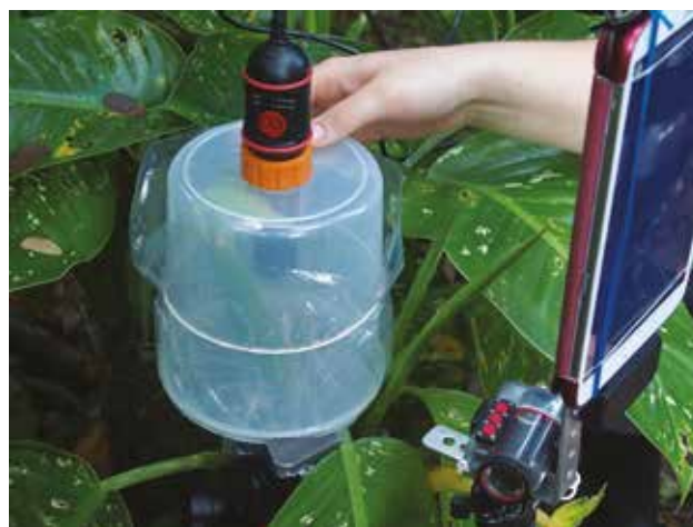
Ryc. 11. Komora metaboliczna nałożona na kwiatostan difenbachii. Fot. J. Weiner.
