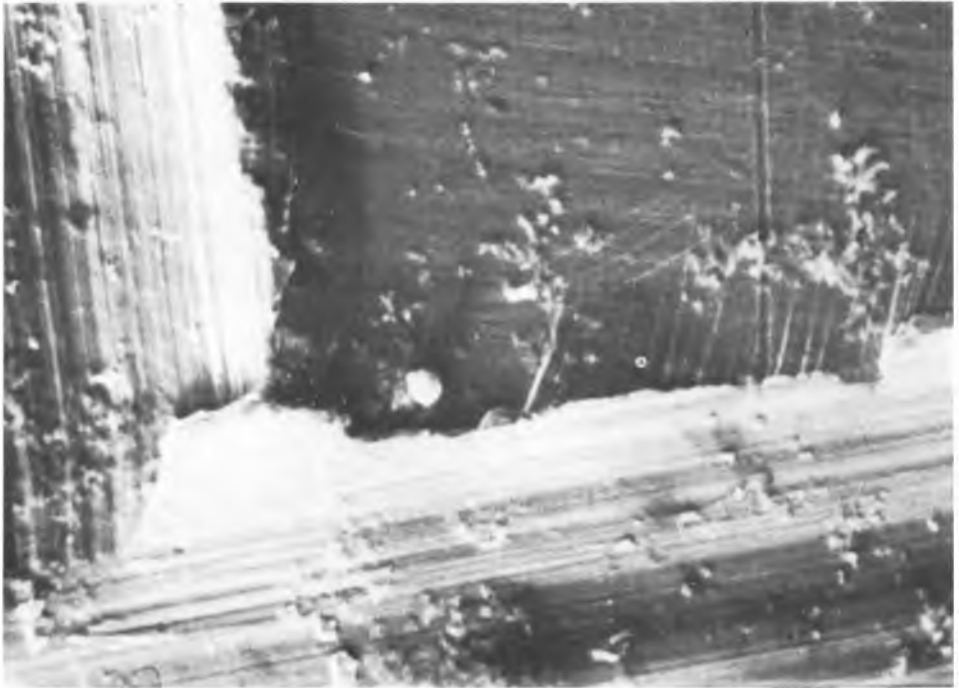
Ryc. 5. Wszczep ze stopu Medpol-2, 6 mies. po implantacji, przed oczyszczeniem. Pow. 1000 × Six-month implant of Medpol-2 alloy before cleaning. Magn. 1000 ×
