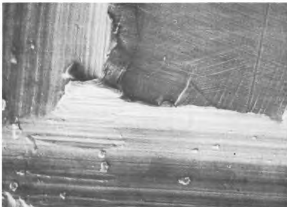
Ryc. 6. Wszczep ze stopu Medpol-2, 6 mies. po implantacji, oczyszczony z resztek organicznych. Pow. 1000 ×
