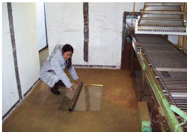
Fot. 1. Badania mocy dawki wokół transportera akceleratora elektronów. Do dozymetrii zastosowano folię z nieplastifikowanego PCW. Stalowa rura miała na celu pochłonięcie rozproszonych elektronów (pomiar promieniowania hamowania).
