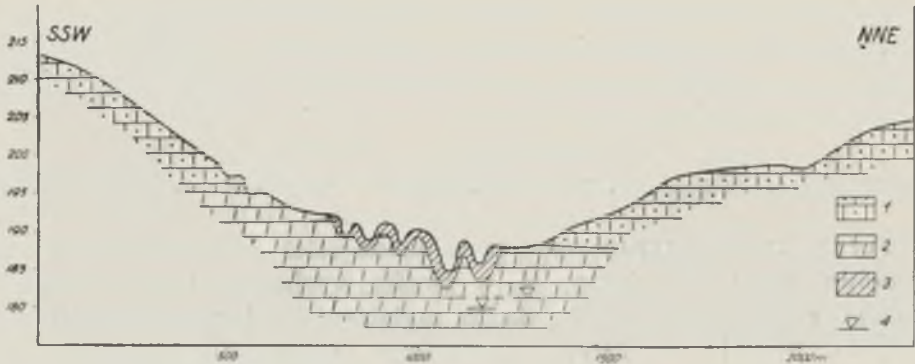
Ryc. 2. Profil geologiczno-morfologiczny przez dolinę Krępieca. 1 — skały danopaleocenu, 2 — skały górnego mastrychtu, 3 — osady czwartorzędowe, 4 — położenie powierzchni wód gruntowych.
