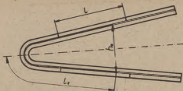
Ryc. 2. Schemat wiskozymetru w wersji V-rurki
