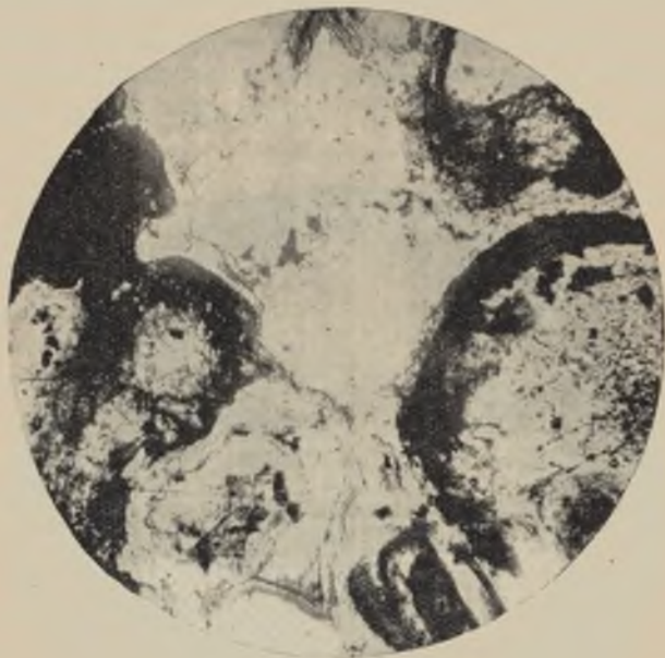
Ryc. 17. Sarmat. Gruszów k. Rejowca. Zlep muszlowy z żelazistymi i krzemioakowymi obwódkami dokoła ziarn kwarcu. Charakterystyczna włóknista budowa spoiwa, ujawniająca się w świetle zwyczajnym. Powiększenie ogoło 60 x.
