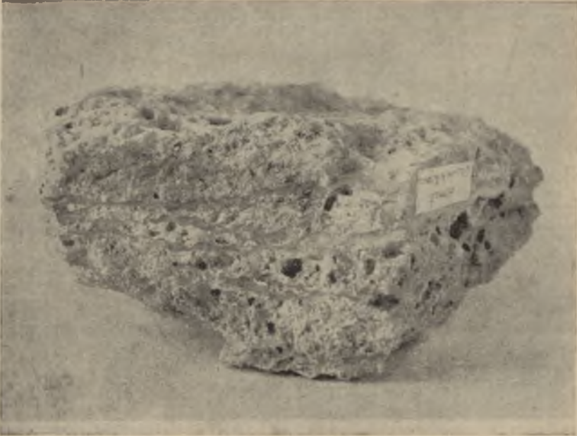
Ryc. 1. Sarmat. Gruszów k. Rejowca. Piaskowiec o budowie gąbczastej impregnowany żyłkami chalcedonu.
