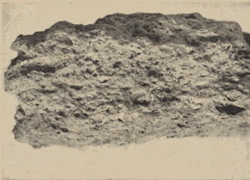
Ryc. 10. Sarmat. Horodyszczce k. Chelma. Zlep muszlowy oolityczny, warstwowany z wkładkami żelazystymi.
