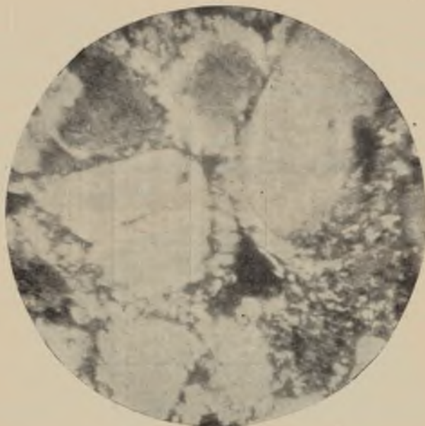
Ryc. 13. Sarmat. Janów k. Chełma. Piaskowiec o spoiwie chalcedonowym. Światło spolaryzowane, nikole skrzyżowane Powiększenie około 60 x. Fig. 13. Sarmatian sandstone with cement of chalcedony. Crossed nicols.
