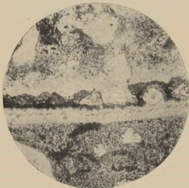
Ryc. 14. Sarmat. Horodyszczce k. Chełma. Zlep muszlowy piaszczysty z żyłką syderytowo-chalcedonową. Światło spolaryzowane. Nikole skrzyżowane. Powiększenie około 60 x. Fig. 14. Sarmatian shell conglomerate with siderite-chalcedony veinlet. Crossed nicols.
