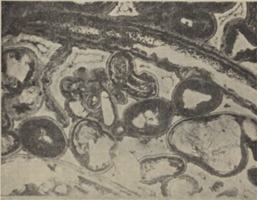
Ryc. 18. Sarmat. Góra Boży Dar k. Piotrkowa Lubel. Oolit krzemionkowo-żelazisty. Światło zwyczajne. Powiększenie około 25 x.
