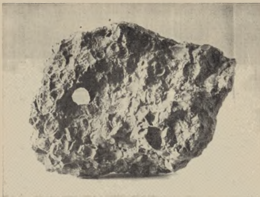
Ryc. 4. Sarmat. Janów k. Chełma. Skrzemieniasty zlepek muszlowy z otworem po wypadłej muszli. Fig. 4. Sarmatian silicificated shell conglomerate. Janów n. Chełm.
