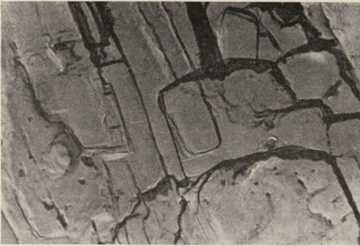
Ryc. 2. Romboedryczne kryształy magnezytu z Sobótki. Zdjęcie w mikroskopie elektronowym — pow. ok. \times 30\ 000
