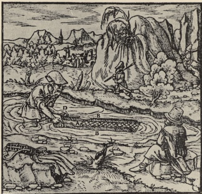
Abb. 13. Goldwaschen im 16. Jahrhundert (Agricola, „De re metallica“).
