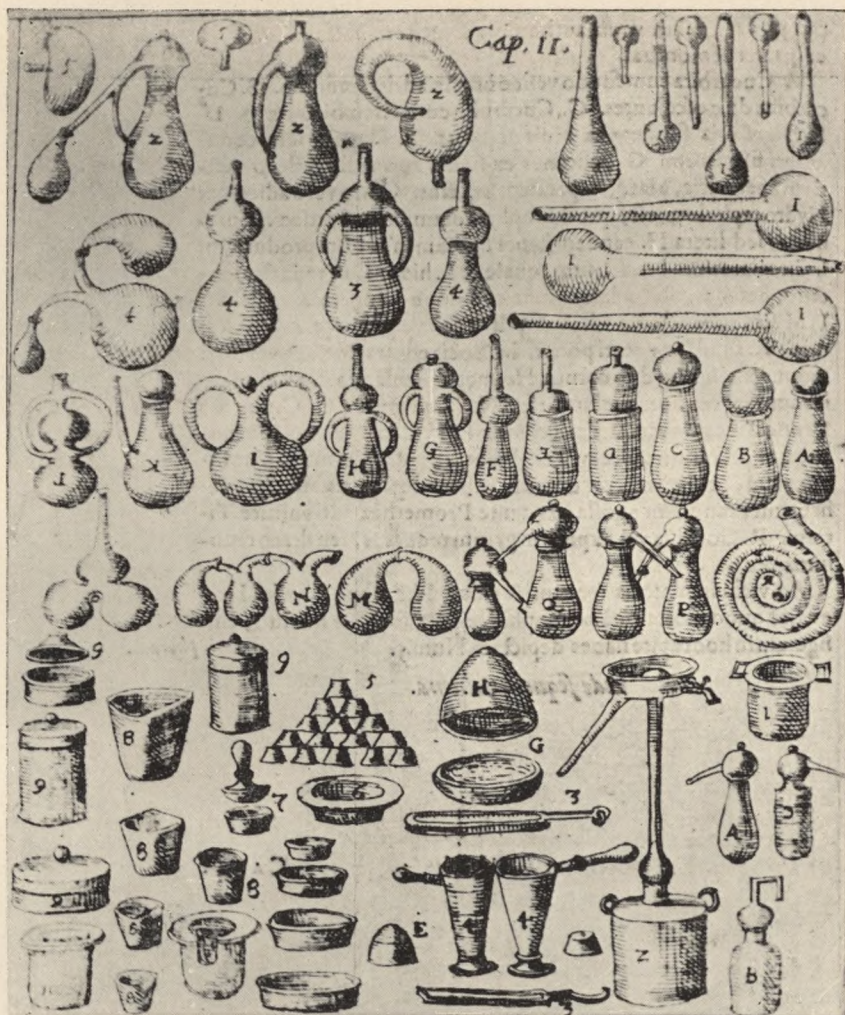
Abb. 23 Chemische Glasgeräte aus dem 16. Jahrhundert. (Mylius, „Basilica“ 1610).
