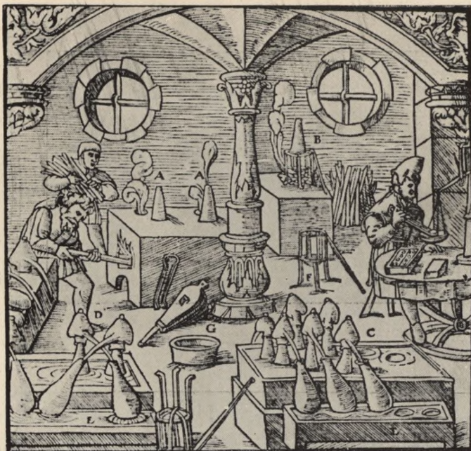
Abb. 17. Chemisches Laboratorium im 16. Jahrhundert. Der Probierer (rechts) legt die Gewichte mittels einer Pinzette auf die Schale. (Agricola, „De re metallica“).
