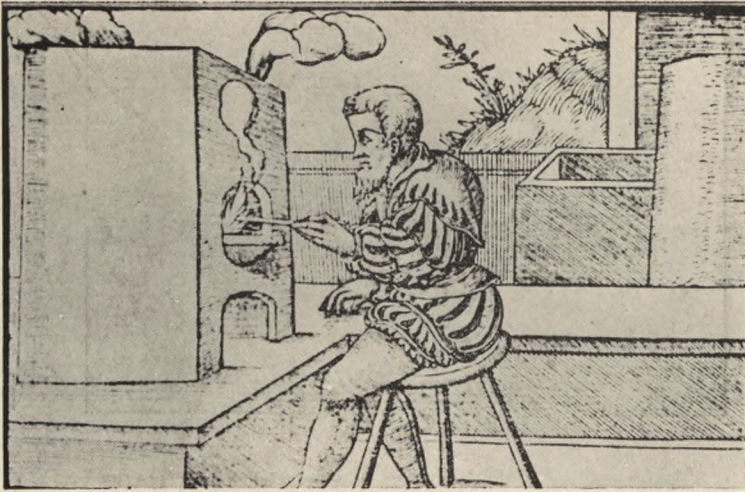
Abb. 1. Probierer am Probierofen. (Agricola, „De re metallica“).
