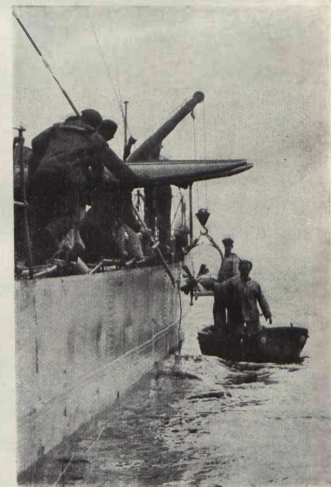
Torpeda bojowa jest tak skonstruowana, że chybiwszy celu automatycznie tonie. Natomiast torpeda, używana do ćwiczeń, wypływa na powierzchnię wody. Ilustracja daje moment podnoszenia z wody torpedy ćwiczebnej.
