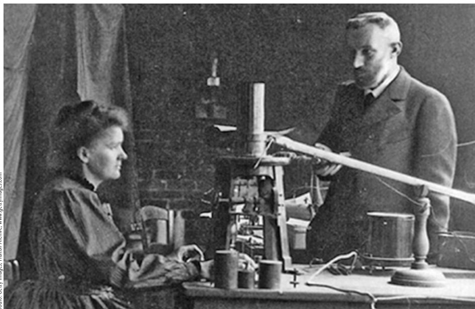
• Maria i Piotr Curie przy pomiarach promieniowania, na środku kwarc piezoelektryczny (1902 r.)
