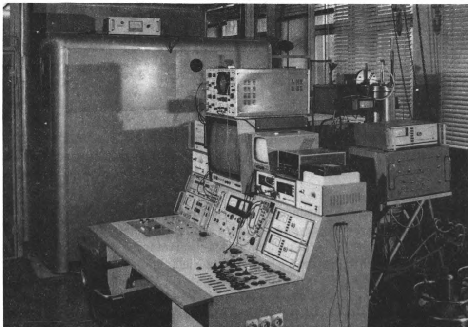
Fot. 1. Widok implantatora jonów UNIMAS od strony kolektora. Na pierwszym planie — pulpit sterowniczy, w głębi — kopuła 300 kV
